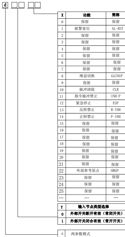
图 8.3.1 可编程输入端子功能设定示意图
