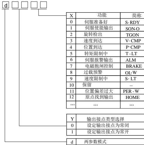
图 8.3.2 可编程输出端子功能设定示意图
